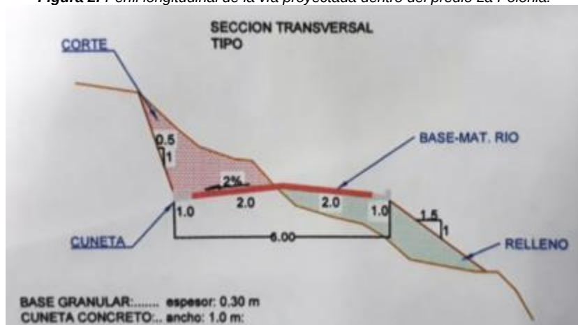
Figura 3: Detalle sección tipo de la vía.
