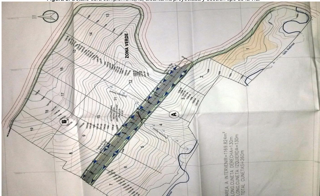
Figura 4: Detalle en planta de la vía proyectada.
