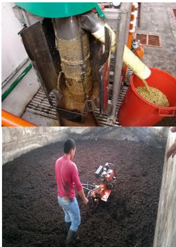
Utilización de Becolsub y aireación y volteo de pulpa con rotavirus con aplicación de M.E.
