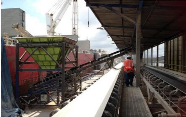
**Para el sistema de descargue se utilizará una de las bandas que hoy no opera la terminal, exactamente la lado tierra., la cual esta sobre artesas de rodillos, que se han dispuesto paralelas a la línea de “aproche”; este sistema de bandas permite recibir sobre ellas el producto o productos descargados sobre las tolvas y llevarlo hasta la bodega especializada.**
