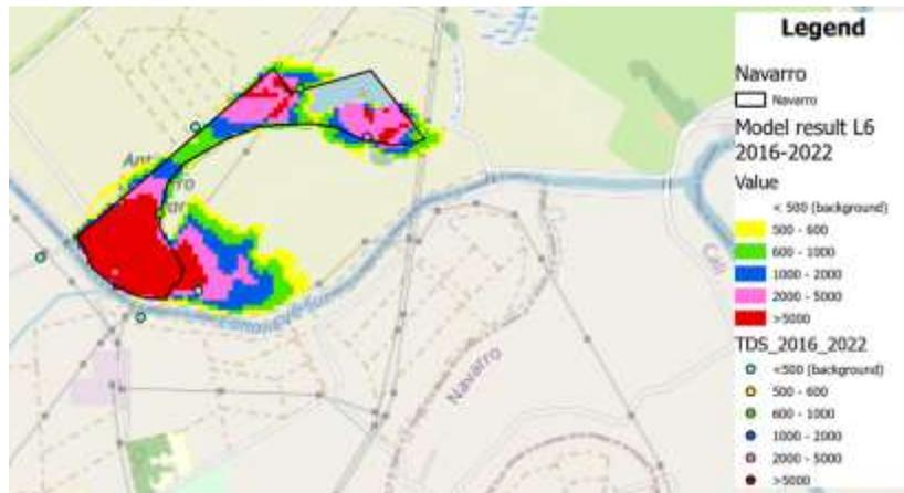
Ilustración 7. Resultados del modelo numérico para el año 2022 mostrando la concentración de Sólidos Disueltos Totales a 7.5-8m de profundidad desde la base del vertedero.
