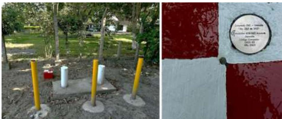
Foto 65. Detalle de punto de nivelación topográfica y placa de información (GNSS-B3). Archivo CVC.
