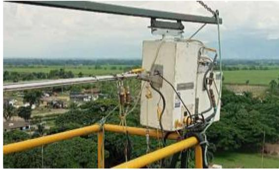
Foto 106. Equipo de muestreo instalado en la chimenea de un ingenio. Archivo CVC. 2023
