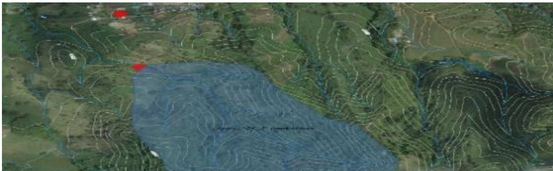
Área aferente del punto de captación, quebrada sin nombre
