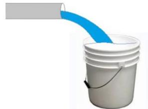
En el caso de realizar esta medición por el método volumétrico se deben tomar datos de tiempo de llenado a lo largo de la prueba y se debe registrar o calcular el volumen exacto con el cual se están tomando los tiempos de llenado.
