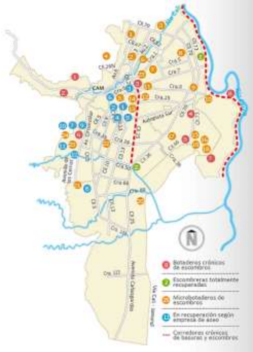
Foto 508. Distribución de los sitios de disposición de los RCD en Santiago de Cali analizados La Universidad del Valle diseño e implementó la metodología de muestreo para posteriormente realizar la caracterización:
