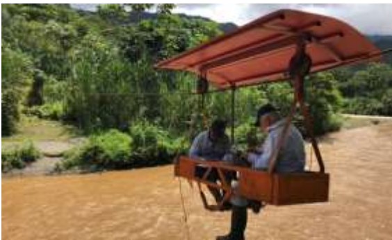
Foto 104. Aforo desde tarabita en la estación Bendiciones, río Dagua, Grupo Recursos Hídricos, DTA. 2018
