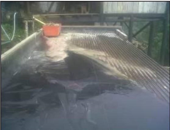
Mesa de concertación para recuperación de mercurio en pasivos ambientales (arenas y lodos), sector La Esperanza – municipio de Guacarí.
