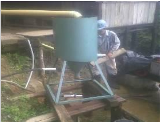
Elutriador para captura de mercurio en arenas y pasivos ambientales, municipio de Guacarí.
