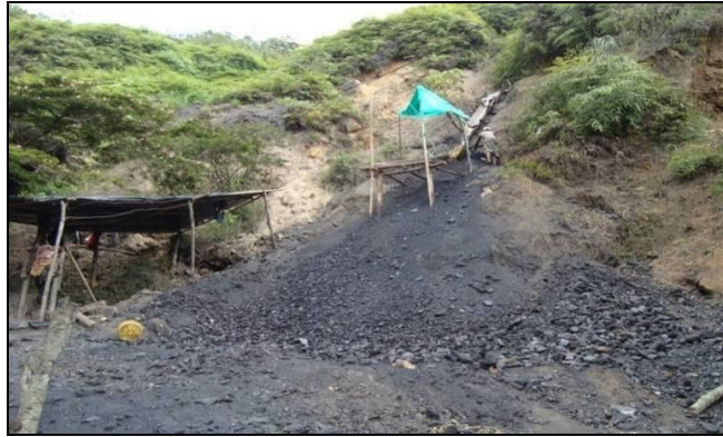
Presencia de minería artesanal de carbol cerca del río Meléndez, en condiciones antitécnicas en terrenos inestables por movimientos en masa.
