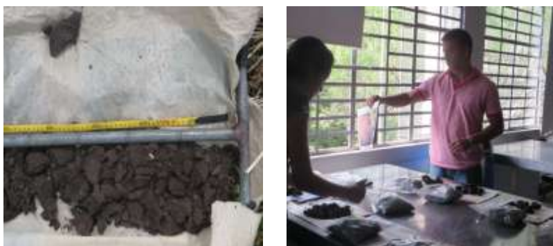
Toma de muestras no disturbadas columnas 6 pulgadas y verificación de perfiles
