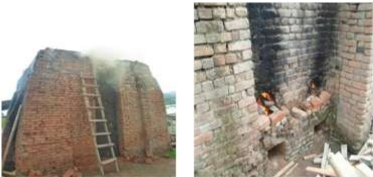
Tipo de aireación Horno con gran escape de gases
