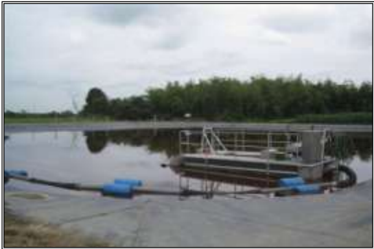
Draga para extracción de lodos de vinaza con bomba hidráulica axial Ingenio Manuelita
