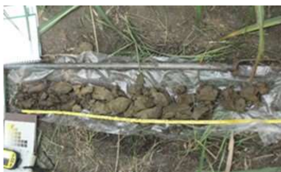
Foto 7. Descripción de campo de suelo a una profundidad de 120 cm
