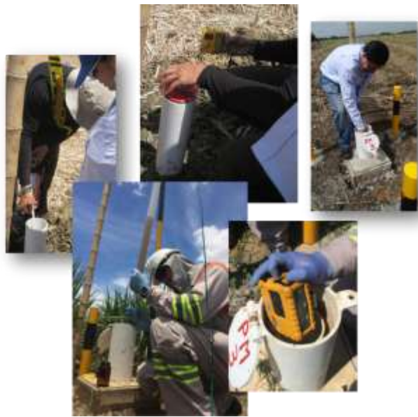
Figura 120. Muestreo de compuestos orgánicos volátiles y medición de niveles. Hacienda Bermejál, municipio de Yumbo. Fuente: Grupo Recursos Hídricos, DTA. 2015
