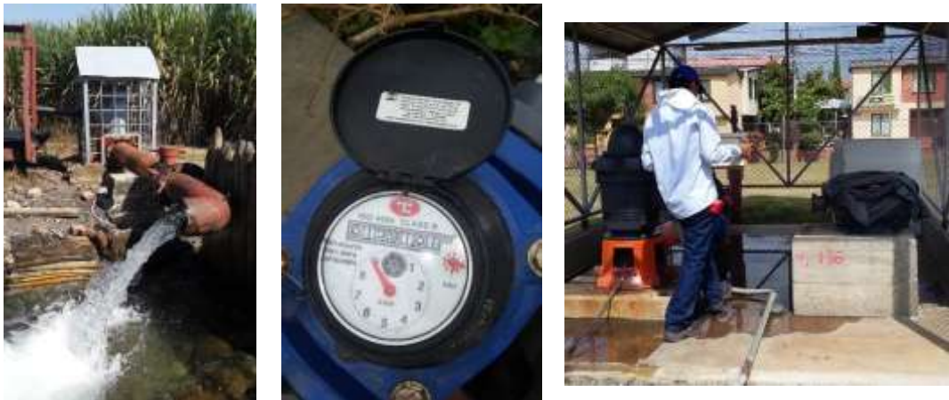
Figura 164. Trabajo de campo para la lectura de contadores, medición del volúmenes de agua extraída de los pozos. Fuente: Grupo Recursos Hídricos, DTA. 2015
