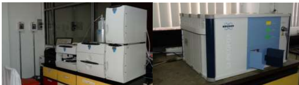
Figura 186. Reconversión Tecnológica del Laboratorio, Equipo de Cromatografía Iónica y Equipo de Rayos X para análisis de metales
