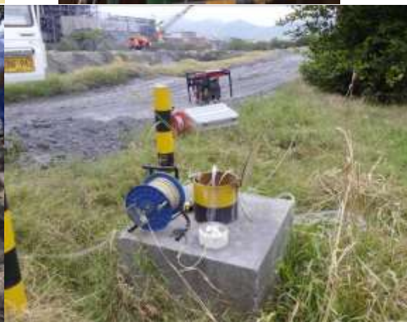
Proceso de monitoreo de pozos. Fuente: grupo Recursos Hídricos – DTA - CVC
