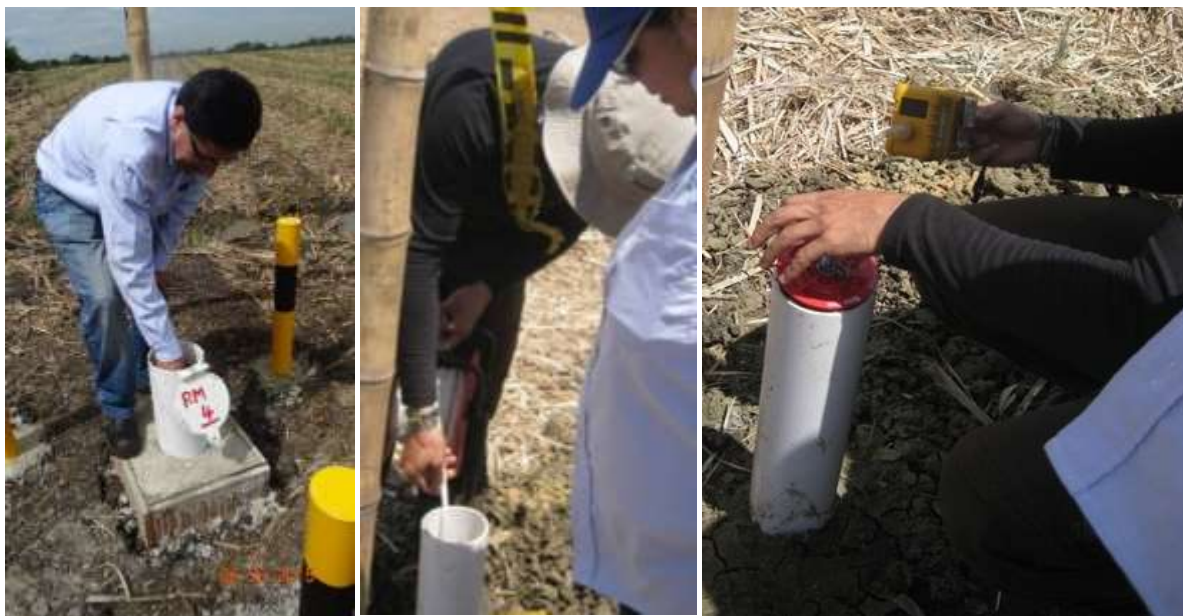
Muestreo de compuestos orgánicos volátiles y medición de niveles. Hda. Bermejál, municipio Yumbo. Fuente: grupo Recursos Hídricos – DTA – CVC.
