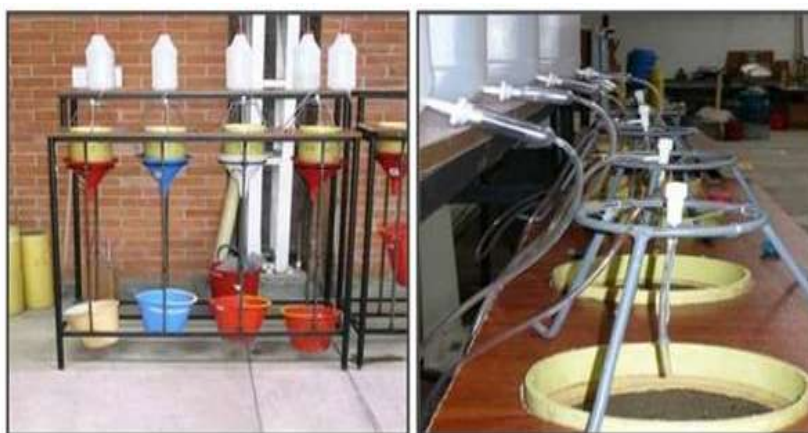
Componentes de la instrumentación utilizada para la realización de las pruebas de conductividad hidráulica Saturada y los experimentos de desplazamiento Miscible
