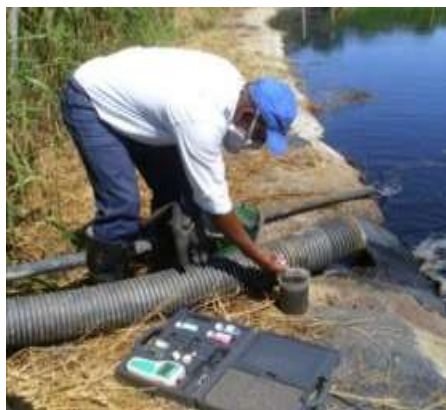
Monitoreo de la calidad de aguas y vertimientos en un efluente industrial y en un río
