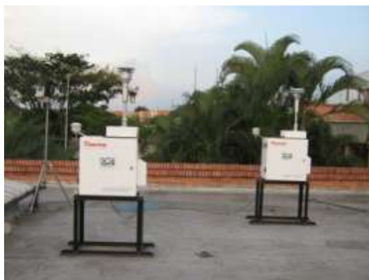
Equipos Secuenciales para monitoreo de la calidad del aire ubicados en Acopi – Yumbo
