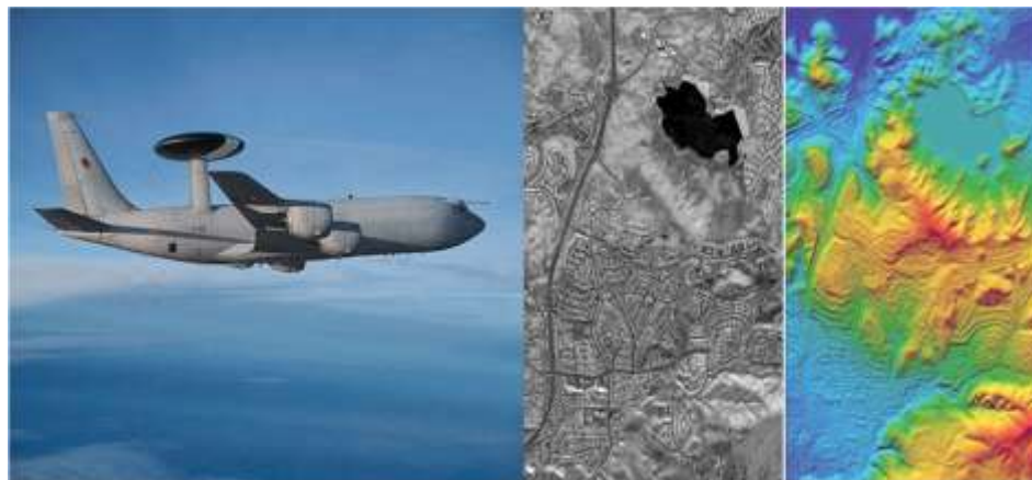
Imágenes detalladas de radar aerotransportado con alta resolución espacial 0.5m. De pixel sin limitaciones por nubosidad incluso las tomas pueden ser nocturnas.
