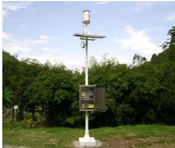
Automatización para la toma de datos hidroclimatológicos; estaciones con sensores modulares para la evaluación de las variables o parámetros hídricos y de clima.
