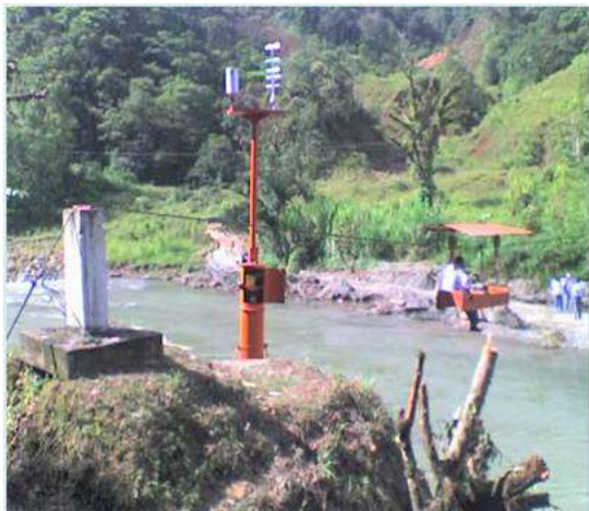
Automatización para la toma de datos hidroclimatológicos; estaciones con sensores modulares para la evaluación de las variables o parámetros hídricos y de clima.
