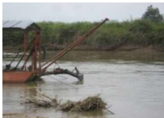
Draga con adaptación de cuchilla de corte en la entrada para disgregar el material.
