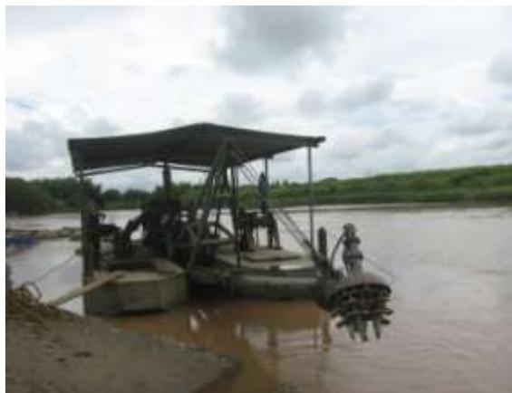
Fotos Draga con adaptación de cuchilla de corte en la entrada para disgregar el material.
